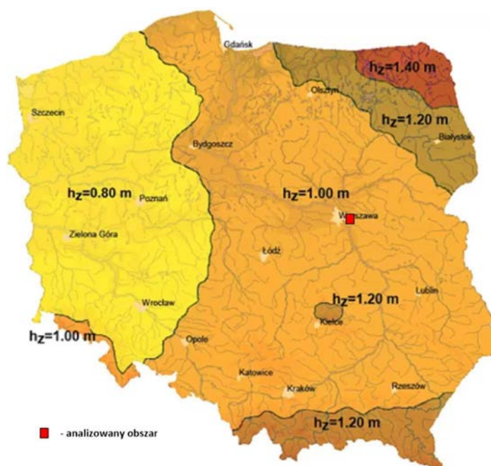
Ryc. 1. Głębokość przemarzania gruntów wg PN-81/B-03020.
